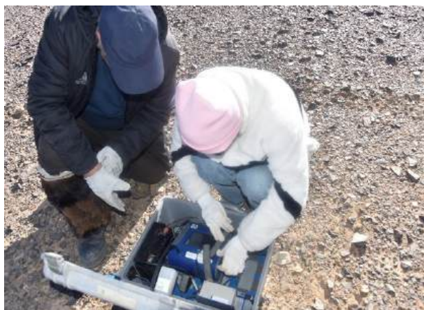
OIZOM POLLUSENSE болон DustTrak™ DRX Aerosol Monitor багажаа ажиллуулж 24цагийн турш ажиллаж буй зураг
